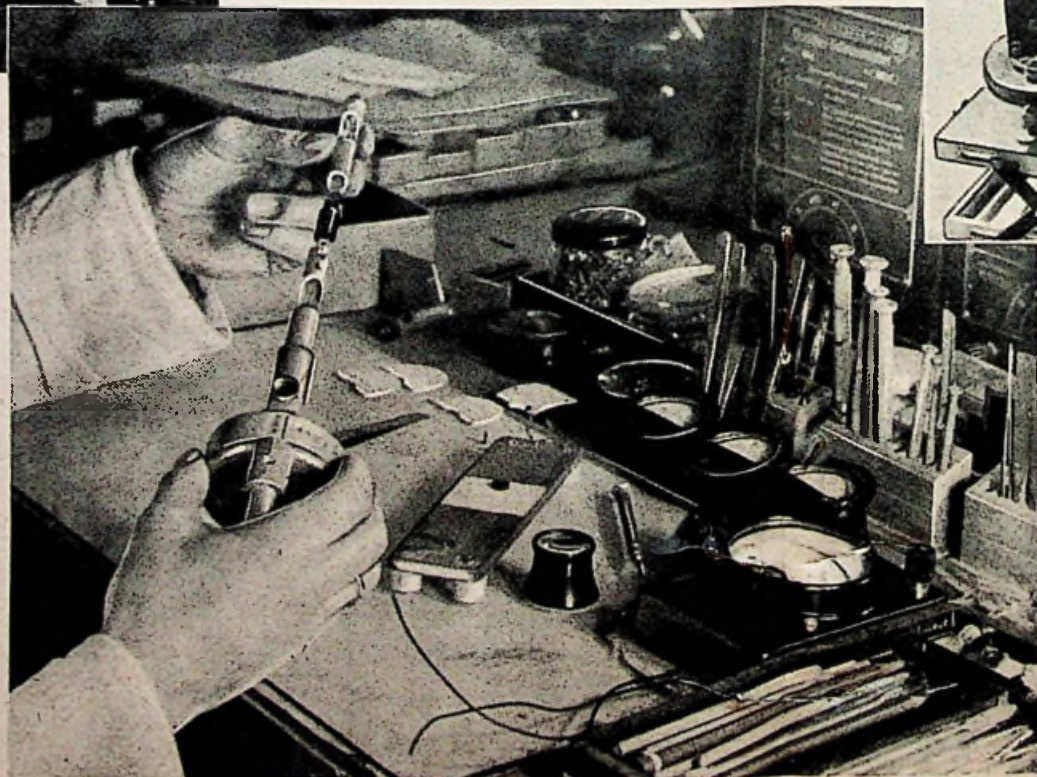
Wickeln der temperaturunabhängigen Manganinwiderstände für die verschiedenen Meßbereiche, eine Arbeit für gewissenhafte Fachkräfte
